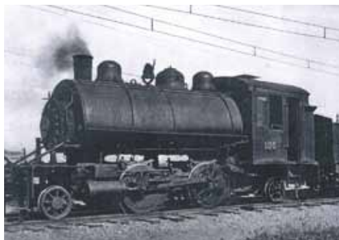
宇部鉄道 形式205 No.100 日本では珍しかったサドルタンク式蒸気機関車
